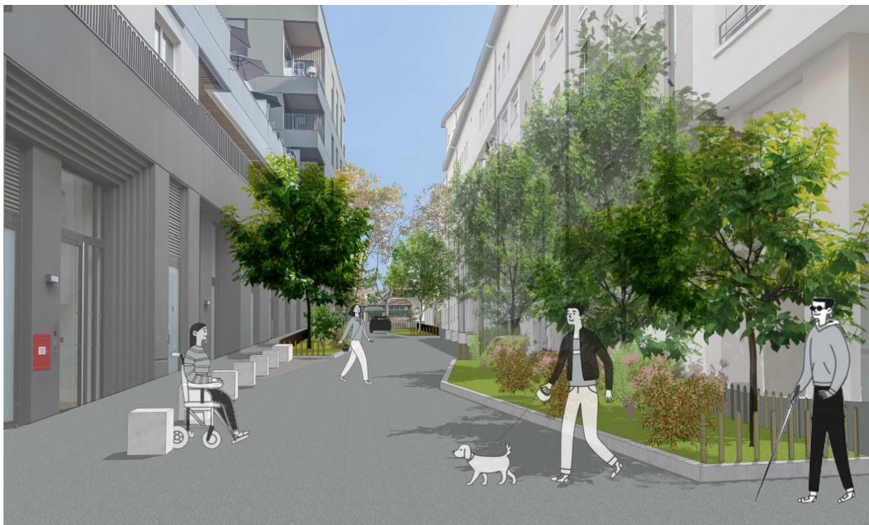
Croquis d'une zone de rencontre type avec des bandes plantées qui cassent la linéarité et créent des zones refuges pour les piétons
