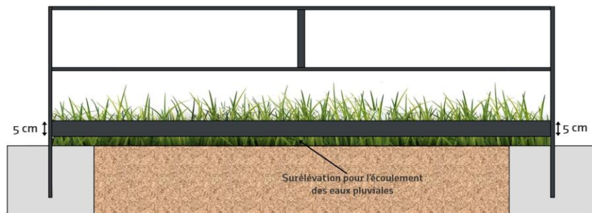
Schéma de lisse basse doublée à 5 cm du sol
