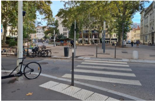
Paire de balises sonores qui permettent un guidage en traversée
