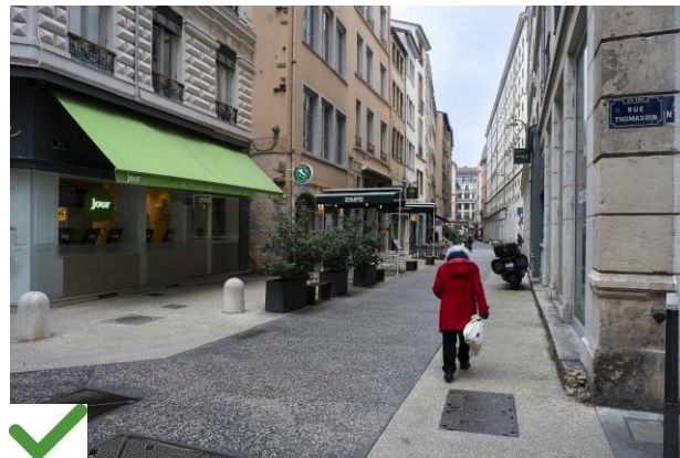
Photo 1 : Le ressaut entre la zone circulée et le cheminement piéton est rendu visible par la différence de revêtement
