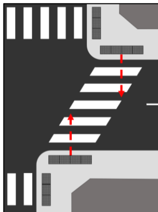
Représentation schématique de la problématique d'un passage piéton en biais
