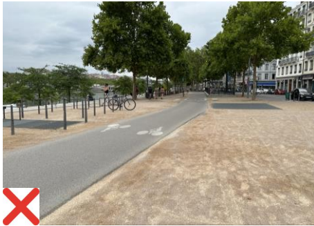
La piste cyclable a un revêtement plus confortable que le trottoir : elle risque d'être utilisée par les piétons
